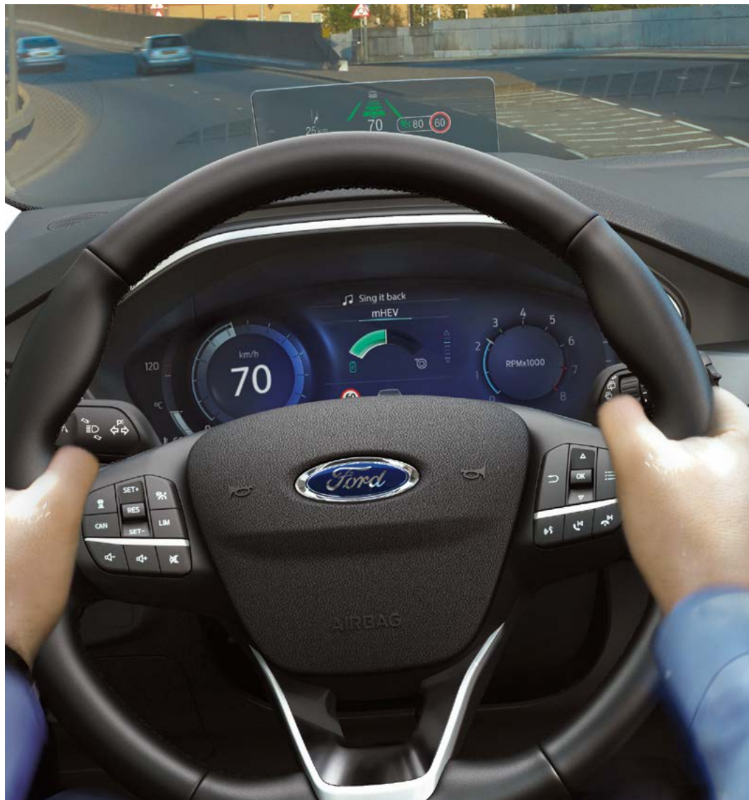
Ford Focus Active X z 12.3" konfigurowalnym wyświetlaczem na tablicy zegarów (standard) oraz wyświetlaczem przeziernym (opcja)
