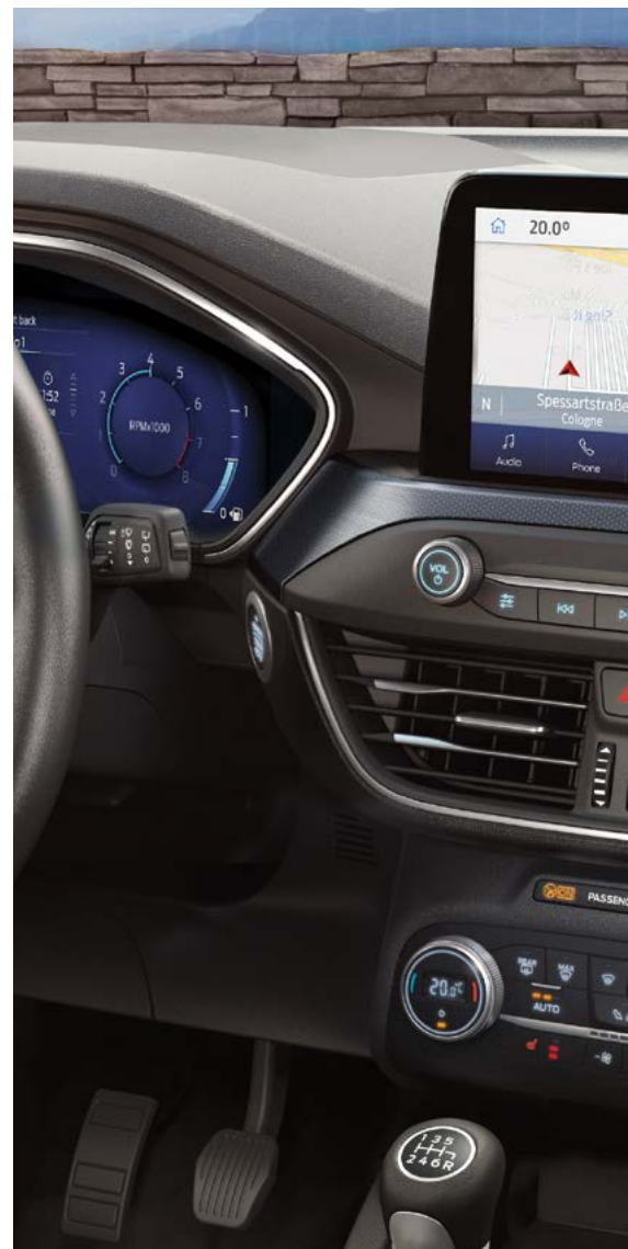
Ford Focus Active X z 12.3" konfigurowalnym wyświetlaczem na tablicy zegarów
