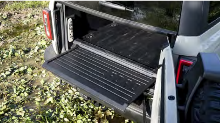
WYSUWANY STOPIEŃ POD PODŁOGĄ DRZWI BAGAŻNIKA
