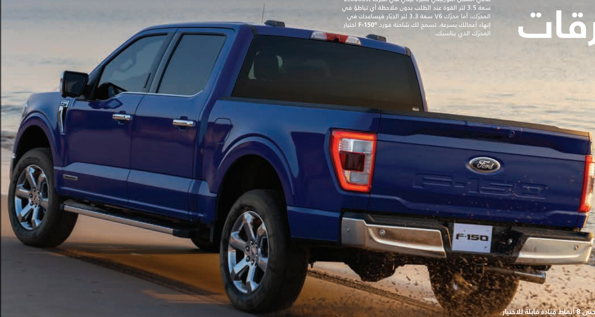
محرّك ECOBOOST سعة 3.5 لتر 3 قوة قصوى 400 حصان و677 نيوتن متر أقصى عزم دوران
