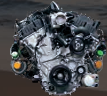
محرّك ECOBOOST سعة 3.5 لتر 3 قوة قصوى 400 حصان و677 نيوتن متر أقصى عزم دوران
