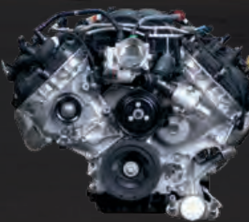
محرّك Ti-VCT V8 سعة 5.0 لتر 4 قوة قصوى 400 حصان و555 نيوتن متر أقصى عزم دوران
