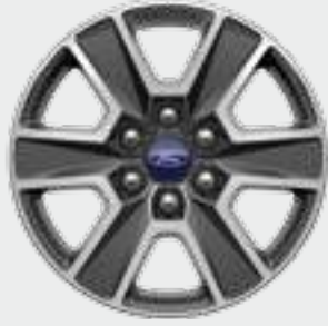
عجلات من الألمونيوم المشغول بـ ٦ شعاعات ١٨ بوصة مع جيوب مطليّة باللون الرمادي المغناطيسيّ - مضقنة، مجموعة التجهيزات الرياضية لاريات - مضقنة، مجموعة التجهيزات الرياضية
