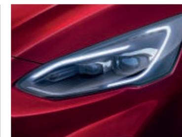
**Système d'éclairage avec phares technologie Ford Dynamic Full LED, feux de route anti-éblouissement et clignotants à LED séquentiels**
