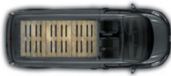
Charge utile brute maximale de 1430 kg (H1)/1395 kg (H2) MMA du véhicule entre 3000 kg et 3400 kg
