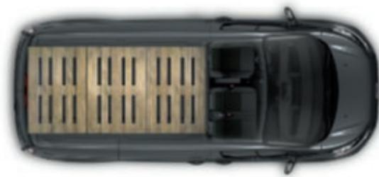
Charge utile brute maximale de 1508 kg (H1)/1481 kg (H2) MMA du véhicule entre 2600 kg et 3400 kg
