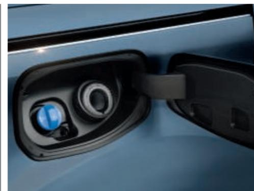
**Système de remplissage sans bouchon Ford Easy Fuel**
