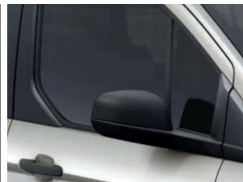
**Rétroviseurs extérieurs chauffants à commande électrique**
